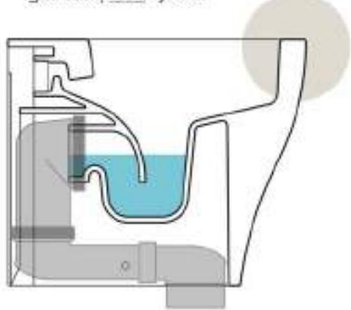
**Plus** est un système d'évacuation conçu pour les wc au sol et conçu spécifiquement pour être adapté aux systèmes de drainages existants, excellent pour la rénovation de salles de bains.
